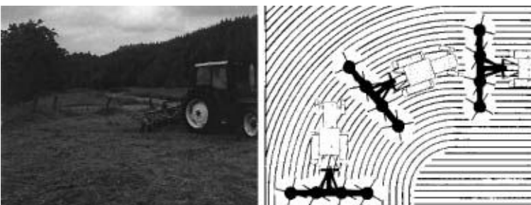
Figuur 9-9: De naloopinrichting zorgt ervoor dat bochten soepel genomen worden.
