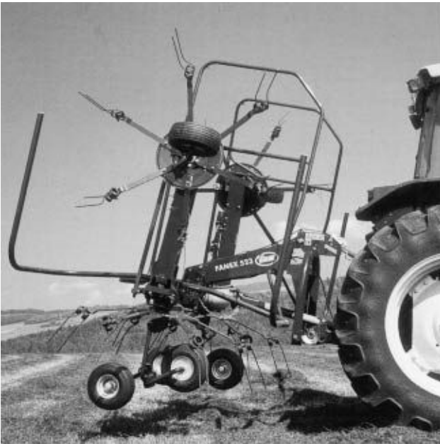
Figuur 9-3: Een aanbouwcirkelschudder met vier schudelementen.
